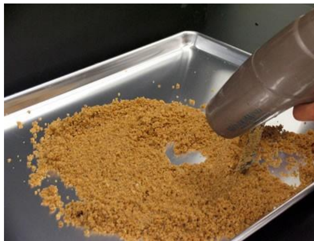
Figura 222 - 1. Secado de la muestra con aire tibio
