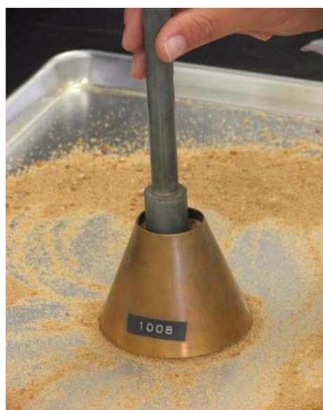
Figura 222 - 2. Aplicación de los golpes con el pisón
