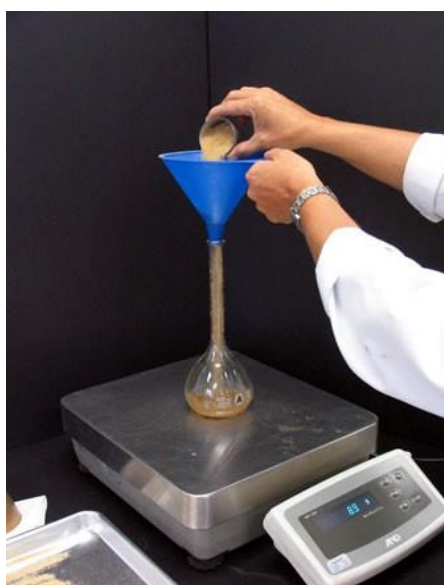
Figura 222 - 4. Introducción de la muestra en el picnómetro
